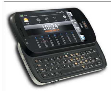
Рис. 4. Смартфон M900 от компании Acer работает на основе процессора S3C6410
