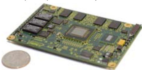
Рис.2. CoM-модуль Catalyst от Eurotech с процессором Atom
