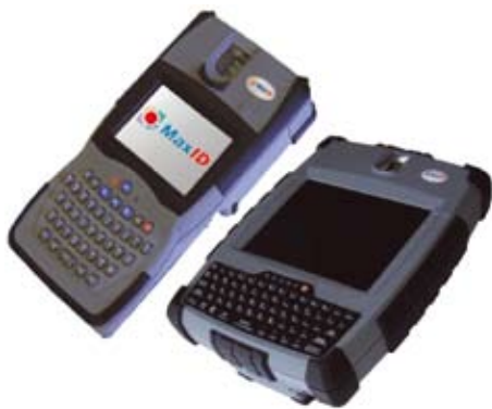
Рис.1. Биометрические устройства iDLMax (слева) и BHC-100 (справа) компании MaxID на основе процессорного модуля Catalyst от Eurotech Group
